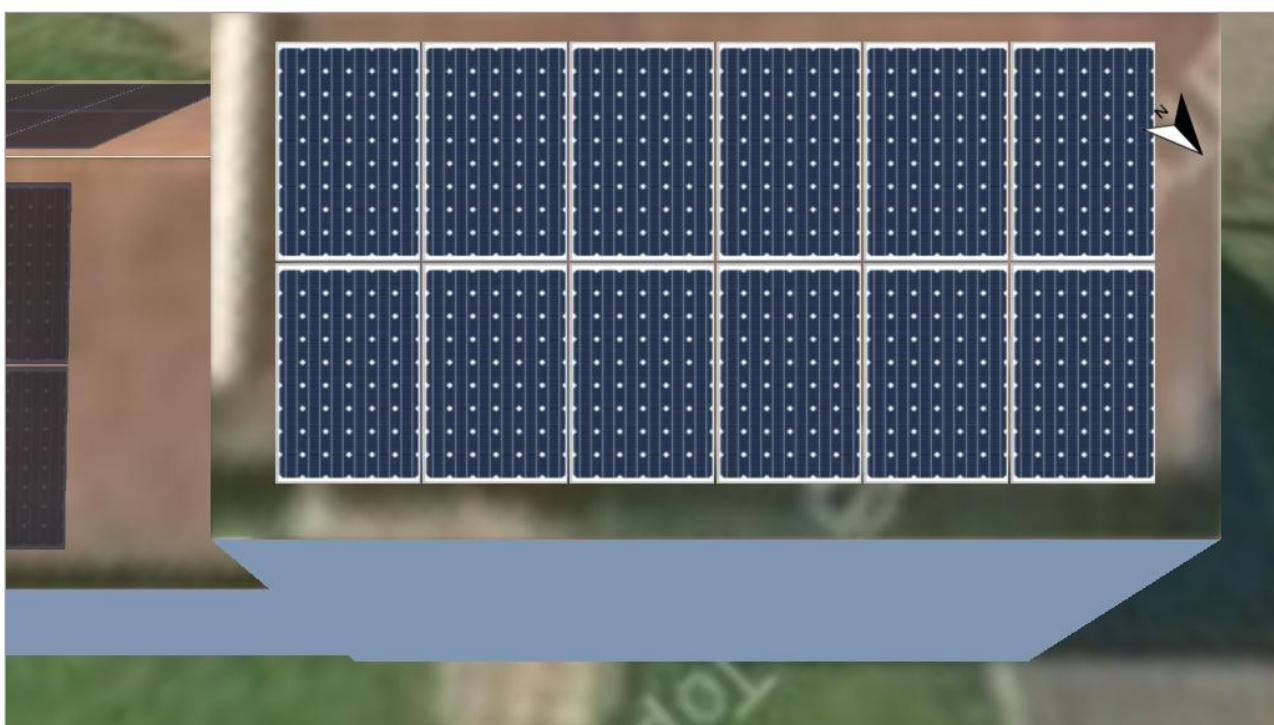
Obrázek: 3. Umístění modulu - Budovy 01-Plocha střechy Severovýchod
